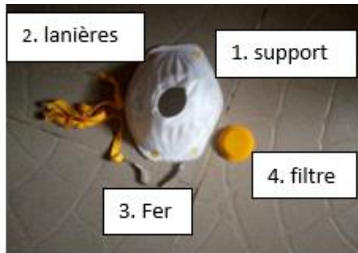
Photo n° 8 : composants d'un masque FFP2
